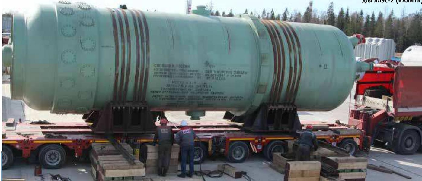
лическая система сдвига грузов (г/п 450 т), гидравлический поворотный круг (г/п 450 т), гидравлическая система бокового смещения груза (г/п 1000 т), тележки и трейлеры (г/п до 120 т), десятки метров рельсов и балок для порталных систем, всевозможные подставки и опоры для грузов. В нашем хозяйстве много специализированного оборудования и инструмента, с помощью которого можно, например, распустить гидравлическую гайку пресса или просверлить отверстия под анкеры в бетонном полу и многое другое.
