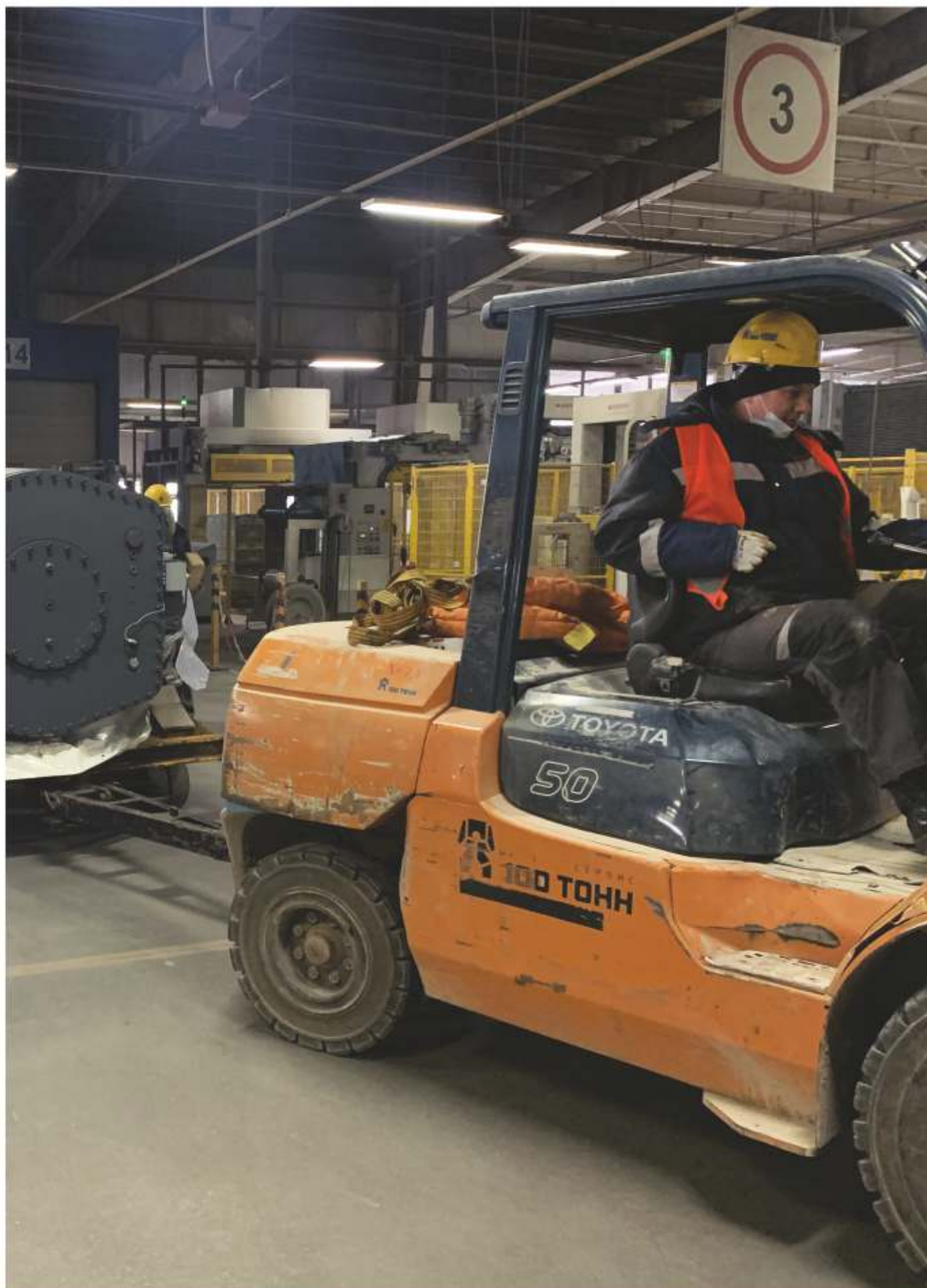
KERAMA MARAZZI, 2022 г., Орёл Выгрузка, перемещение и установка станины пресса SACMI PH1500
